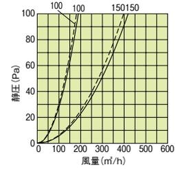
圧力損失曲線図(排気)
